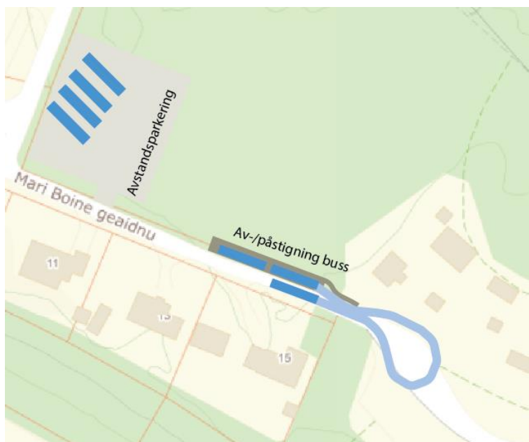
Figur 17: Prinsippskisse buss, kombinert løsning
